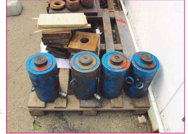
Les vérins qui ont servi à soulever le tablier
